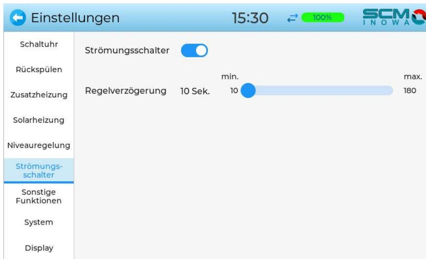
Der Strömungsschalter dient dem Schutz der Filterpumpe und der Heizelemente vor einem Trockenlauf. Durch die kontinuierliche Überwachung des Wasserflusses wird sichergestellt, dass die Pumpen und Heizelemente nur bei ausreichendem Wasserfluss betrieben werden, um Schäden zu vermeiden.
