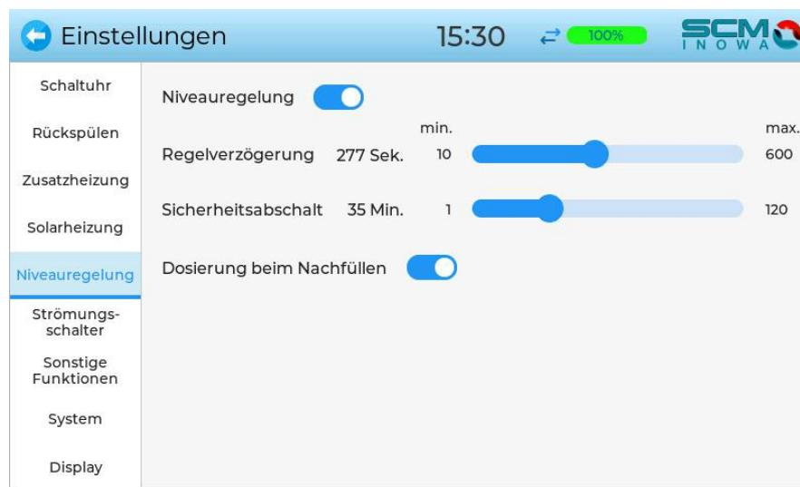
Die Niveau-Regelung dient der Kontrolle und dem Nachfüllen des Wasserstands im Pool, um sicherzustellen, dass der Wasserstand immer auf einem optimalen Niveau bleibt. Sie ist auch für den automatischen Rückspülprozess erforderlich.
